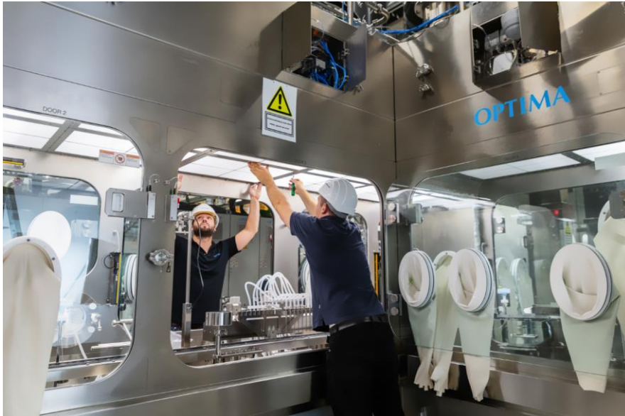
Bei Optima Pharma in Schwäbisch Hall werden die Anlagenkomponenten – bestehend aus Füll- und Verschleißanlage und Isolator – zusammengeführt und unter realitätsnahen Bedingungen in Betrieb genommen. Das spart erheblich Zeit bis zum Produktionsstart beim Kunden. (Quelle: Optima).
